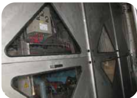
Prensa de banda de tamizado VA DA-120 para deshidratación de fangos de ácido bruto
