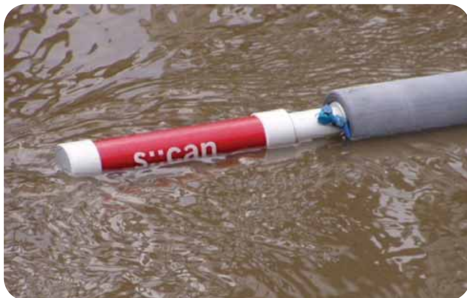
s::can nitro::lyserTM, aplicación en "tanque de aireación"
