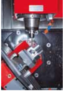
Die EMCO MAXXMILL 500 fertigt komplexe Werkstücke in nur einer Aufspannung. The EMCO MAXXMILL 500 produces complex work pieces in a single clamping operation.
