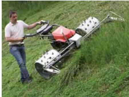
REFORM Bergfex mit ZeroTurn-Lenkung und 2,38-m-Doppelportalmähwerk für extremste Steillagen REFORM Bergfex with zero turn steering and 2.38 meter double portal mower for extremely steep slopes
