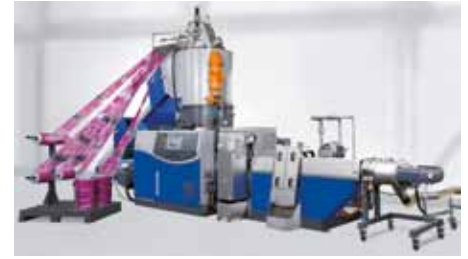
Mit der neuen EREMA TVEplus und ihrer besonders intensiven Hochleistungsentgasung lassen sich selbst stark bedruckte und/oder stark verschmutzte Kunststoffabfälle in einem Arbeitsgang zu hochwertigem Regranulat aufbereiten.
