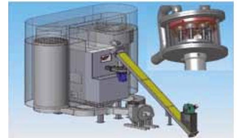
Optimierte Technologie ergab die Möglichkeit, einen Dampferzeuger nach Zwangsdurchlaufprinzip einzubinden Optimized technologie made it possible to integrate a steam generator utilizing the forced flow principle
