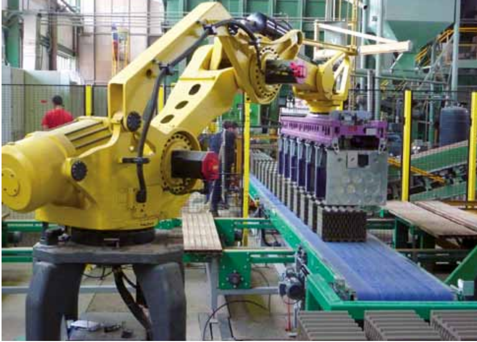
Spezialgreifer für schonendes und schnelles Handling der nassen Ziegel Special gripper for handling wet bricks gently yet quickly
