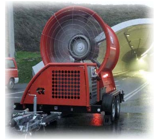
トンネル換気装置
