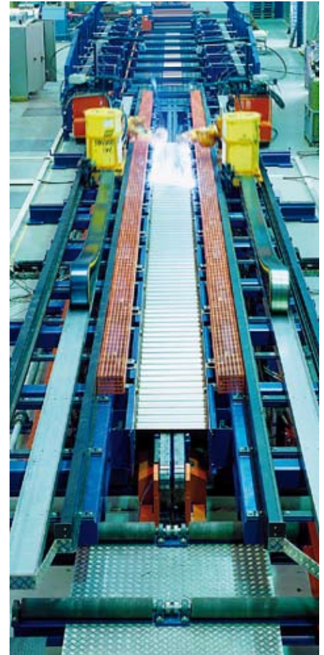
Gesamtansicht einer Herstellungsanlage für SIN-Profile Total view of a production system for sin-profiles
