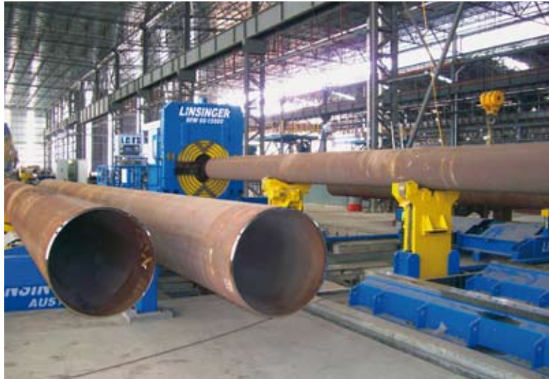
Rohrendenfasmaschine Pipe beveling machine
