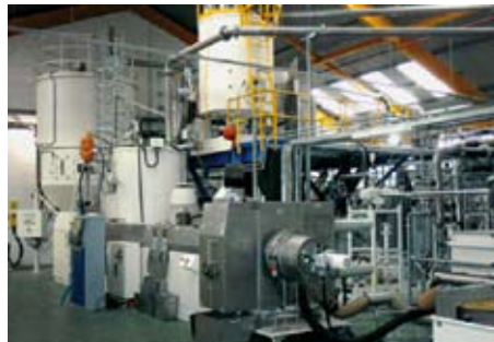
Die Vacurema Advanced 1716 TE-VSV produziert jährlich bis zu 10.000 Tonnen hochwertiges Rezyklat The Vacurema Advanced 1716 TE-VSV produces up to 10,000 tons of high quality recycle a year
