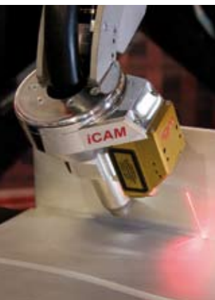
Die Laserkamera iCAM von igm sorgt für lückenlose Nahtverfolgung beim Lichtbogenschweißen The iCAM laser camera ensures complete weld tracking in arc welding
