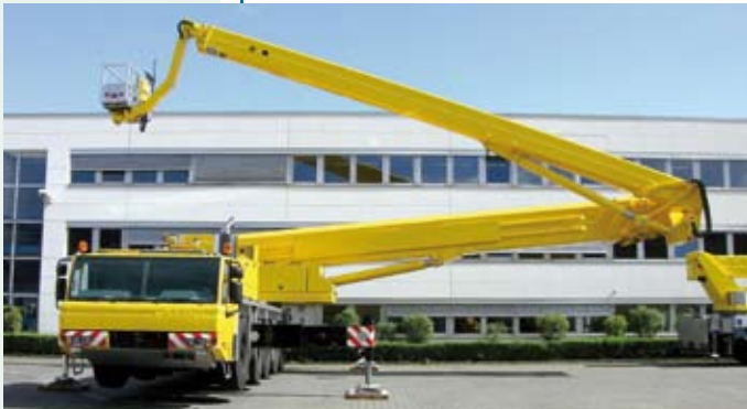
Palfinger WUMAG WT 1000: Mit 103 Metern Arbeitshöhe die weltgrößte Hubarbeitsbühne Palfinger WUMAG WT 1000: The world's biggest work platform, with a working height of 103 meters
