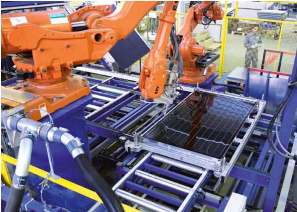
Die neuen Rahmenkollektoren der Linie „Mediterrano“ werden auf einer eigenen Roboterlinie gefertigt The new Mediterraneo line of frame collectors is manufactured on robotic production lines.
