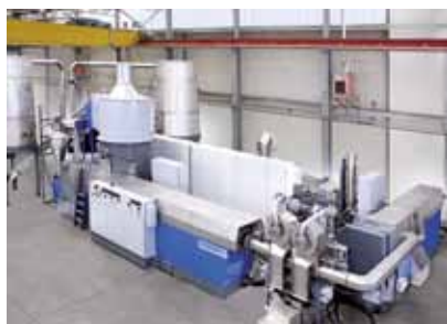
Jean-Paul Dumond setzt mit der 1721 TVE auf Anlagentechnik mit robustem Einschneckenextrusionssystem von Erema
