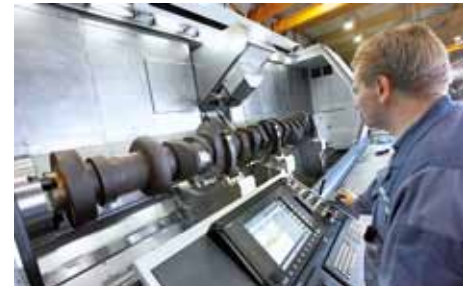
Millturn Technologies macht es möglich: Effizientes Fertigen von großen Kurbelwellen bis zu 8 Meter und 15 Tonnen.
