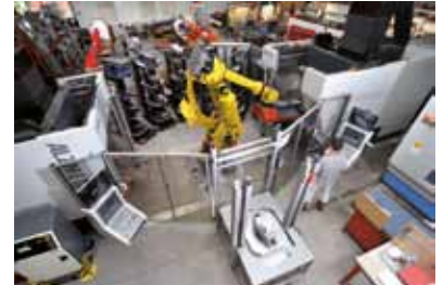
Ein Knickarm-Roboter versorgt die CNC-Bearbeitungszentren mit vorgerüsteten Werkstücken. Das gewährleistet eine hohe Maschinenauslastung und dadurch geringe Fertigungskosten.
