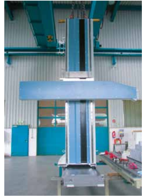
Anwendungsbeispiel: Maschinenbett aus Hydropol, Maschinenständer aus Hydropol Light, Schieber aus Hydropol Superlight.
