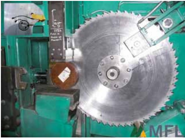
Die neueste MFL-Entwicklung: Sägeblatt mit austauschbaren Karbiden The latest MFL advance: saw blade with exchangeable carbides
