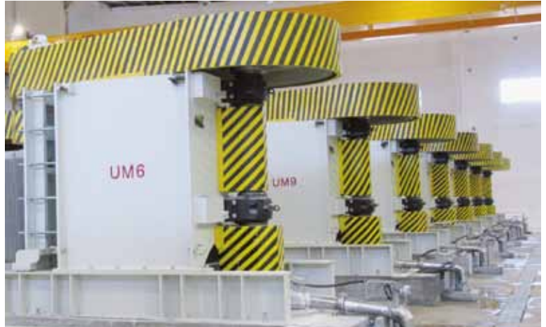
GAW Ultramill: Die vertikale Mühle erlaubt vielseitige Adaptionen.
