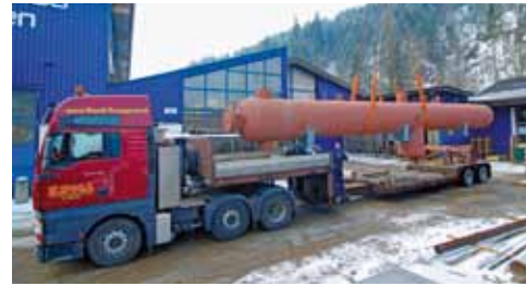
Lieferung der Wärmeaustauscher von APL Apparatebau für ein deutsches Steinkohlekraftwerk
