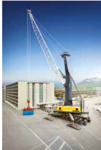
Mit Pactronic wird dem Antriebssystem des Hafenkranes LHM 550 eine zusätzliche Energiequelle hinzugefügt. The Pactronic is a secondary energy source for the drive system of the LHM 550 harbor crane.
