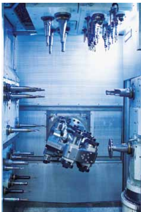
Hybrides Bearbeitungsmodul PS INVERS 3 – Beispiel einer Radträgerbearbeitung in X-Richtung PS INVERS 3 hybrid machining module – example of machining a wheel bearing in X direction
