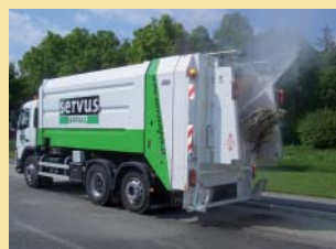
Refuse collection truck with integrated waste collection system. M-U-T Müllsammelfahrzeug mit integrierter Abfallbehälterreinigung.
