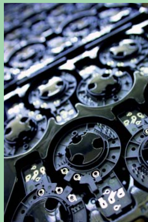
Injection-moulded components. Umspritzte Stanzteile.
