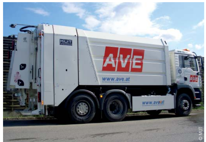
MAN TGM 18.280 mit C-Fahrerhaus als Absetz-Abrollkipper (Bild links), Abfallsammelfahrzeug M-U-T ROTOPRESS 205 (Bild rechts).
