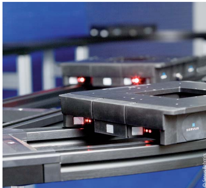
AVL Genios LE – das Magnesium Kraftpaket für Serienproduktion (Bild links). Servus-Roboter benötigen keine zentrale Steuerung, da sie sich aufgrund der eigenen „Intelligenz“ selbst lenken (Bild rechts).
