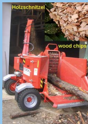
Mk 50 - Chipping of branchwood, logs, wood waste, green pruning... Mk 50 – Zerkleinerung von Ast-/Stamm-/Restholz, Grünschnitt, ...
