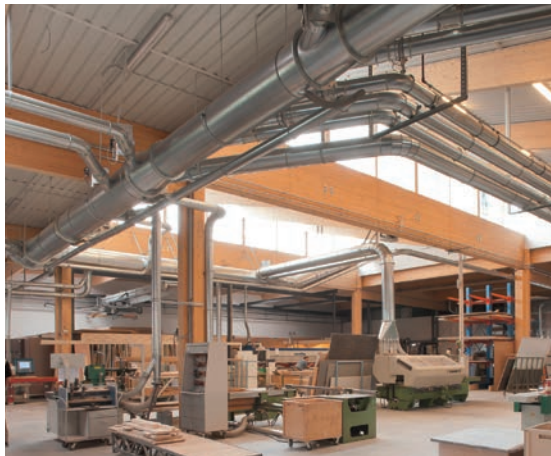
Sistema de extracción de polvo y virutas en carpintería
