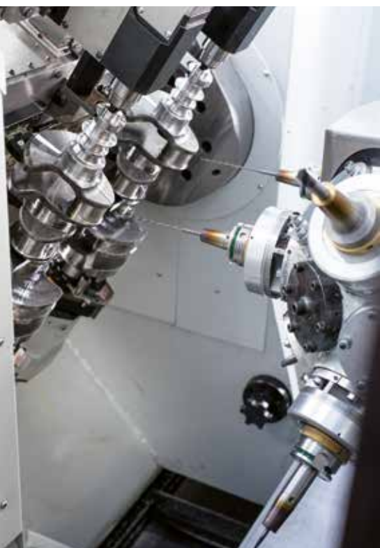
HELLMERICH® 6-fach Kronenrevolver in UNIOR-Maschine zur Trocken- und Doppelbearbeitung von Kurbelwellen HELLMERICH® six-slot crown turret head in UNIOR machine for dry and double machining of crankshafts
