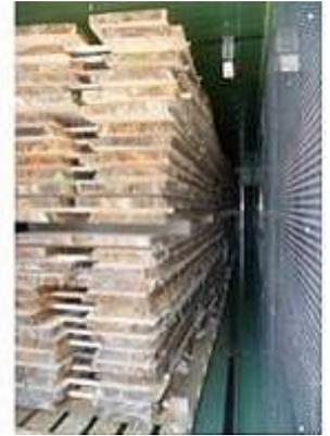
Die patentierte contain dry® - Technologie ermöglicht die Entfeuchtung mithilfe von Unterdruck bei wesentlich geringeren Trocknungstemperaturen (Adsorptions-Trocknung). Neben den wesentlich günstigeren Anschaffungs- und Betriebskosten überzeugt das contain dry® - System auch durch einfache Installation und Bedienung.
