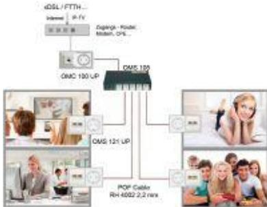
Homefibre bietet ein komplettes, optisches Netzwerk-System an, das sowohl Aufputz als auch parallel mit der Elektroinstallation in Rohren verlegt werden kann. Es eignet sich ideal für eine zukunftsorientierte Installation im Neubau und für die Nachrüstung bestehender Wohnungen.
