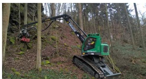
Neuson Forest entwickelt und produziert seit 1995 raupenbasierte Forstmaschinen („Raupen-Harvester“) für den Weltmarkt. Die Produktpalette umfasst Holzerntemaschinen für die Erstdurchforstung bis zur Endnutzung, die in 6 unterschiedlichen Modellreihen (von 12,5t bis 25,5t Eigengewicht) angeboten werden.
