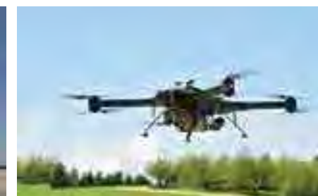
搭载 RiCOPTER 的 RIEGL VUX-1 UAV 激光扫描仪，应用于无人机测绘项目 RiCOPTER with RIEGL VUX-1 UAV LiDAR Sensor for UAV-based surveying missions
