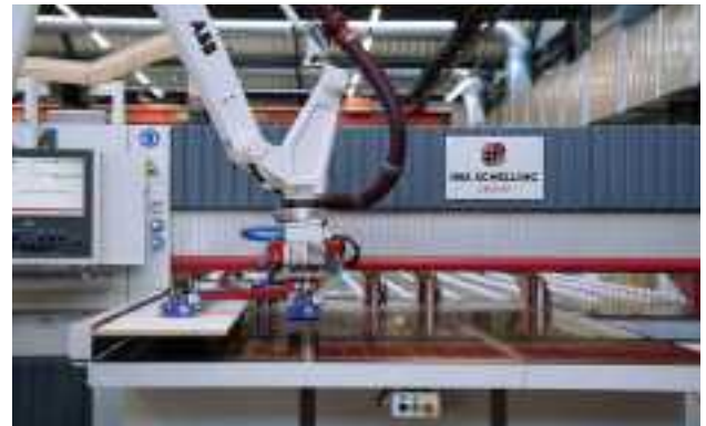
使用机器人自动锯切 automated sawing with Robot.work
