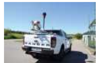
RIEGL VMY-2 移动测图系统 RIEGL VMY-2 Mobile Mapping System
