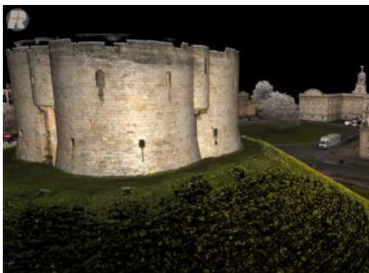
High resolution true coloured point cloud of Clifford's Tower, York Hochauflösende, mit Fotodaten eingefärbte Punktwolke von Clifford's Tower in York
