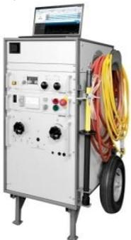
Syscompact 400 portable : Système de localisation de défauts de câbles BAUR : système portable pour la pré- et post-localisation © BAUR GmbH
