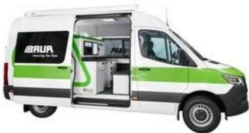
titron@ : Camionnette de test automatique de câbles BAUR : le système intelligent pour la localisation des défauts de câbles, les tests et les diagnostics © BAUR GmbH
