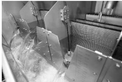
Online mjerni sustav za automatsko evidentiranje protoka na mjernim preljevima i mjernim posudama bez stručnog osoblja. Automatizirani protokoli, vizualizacije putem internetske platforme.
