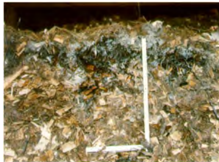
Schimmelbildung an der Schüttungskrone
