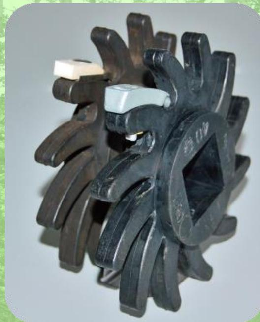
全てのスターセグメントにはそれぞれ一箇所、耐摩耗性のクリーニングフィンガーが装備され1回転毎に隣接軸との間の異物を排除します。さらに隣接するスターセグメント毎の回転速度と回転数を違えることで軸全周の清掃が可能。
