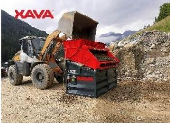
Depuis 2014, l'équipe de XAVA RECYCLING développe et construit dans son usine en Haute-Autriche des cribles vibrants robustes et compacts destinés à diverses applications. Grâce à ces cribles, les matériaux peuvent être séparés sur place, triés en fonction des dimensions requises, réutilisés directement et/ou éliminés proprement, le tout avec simplicité, un usage flexible et une maniabilité maximale.
