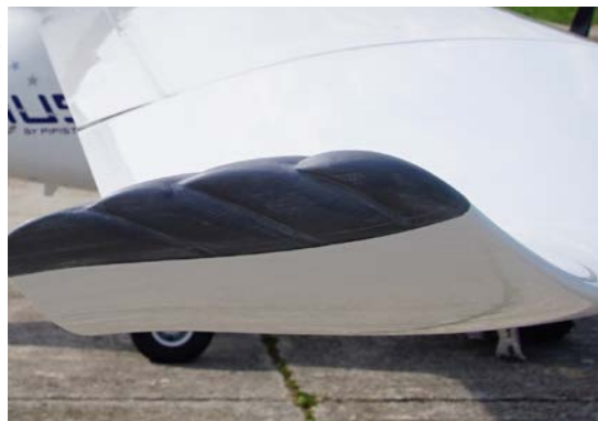
Летные испытания с законцовками SEW на неподвижном крыле
