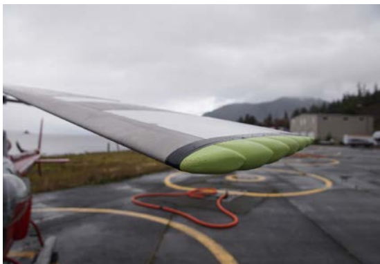
Летные испытания с законцовками SEW на лопастях AS 350 M/R
