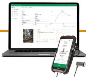
Senseven entwickelt mit Valve Sense das erste intelligente, mobile Inspektionssystem zur einfachen und präzisen Dichtheitsprüfung von Ventilen. Die Lösung basiert auf Schallemissionsanalyse und kombiniert hochwertige Sensorik mit modernen Smartphones – speziell entwickelt für den Einsatz in Ex- und Nicht-Ex-Bereichen – in Kooperation mit dem Marktführer i.safe MOBILE.
